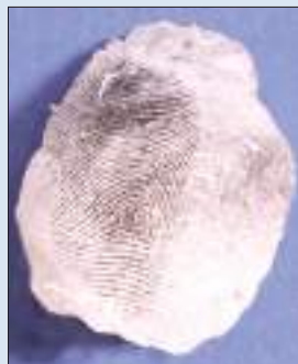
Um levantamento de impressão digital com borracha líquida a partir de uma superfície muito irregular.
