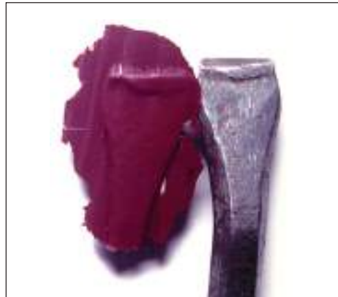
MIKROSIL™ usado para moldar um batente de porta no qual um pé-de-cabra foi usado para forçar a entrada.
