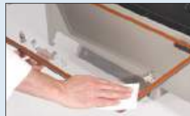
Antes da utilização inicial, trate o interior da porta da câmara com Cyano-Bloc™ para protegê-lo contra a acumulação de cianoacrilato.
