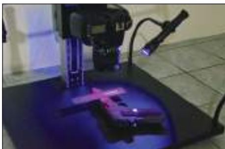
A luz UV (395 nm) em uso com uma câmera digital SLR com macrolentes pode ser usada para fotos tiradas em close das impressões digitais reveladas com pó fluorescente. (Câmera não inclusa)
